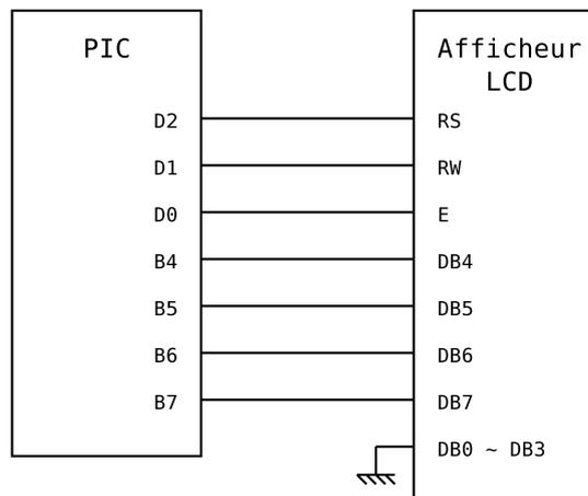
Alimentez alors le PIC et l'afficheur LCD en 5V.
